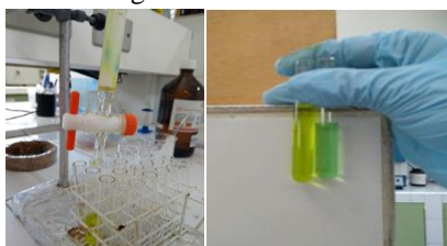
Figura 4. Coluna cromatográfica utilizando amido como adsorvente.
